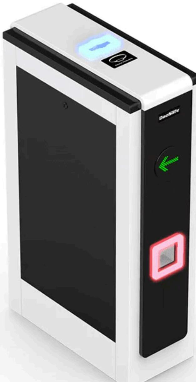
Браслетоприемник DSSP6001E — это оборудование для контроля доступа, позволяющая изымать браслеты. Например, при установке на выходе, если нет запретов (долги, инвентарь на руках и т.д.) - браслетоприемник забирает браслет и турникет проворачивается на выход, а если есть запрет - браслет не принимается, турникет не открывается. Браслет при этом будет выпадать в окно выдачи.
