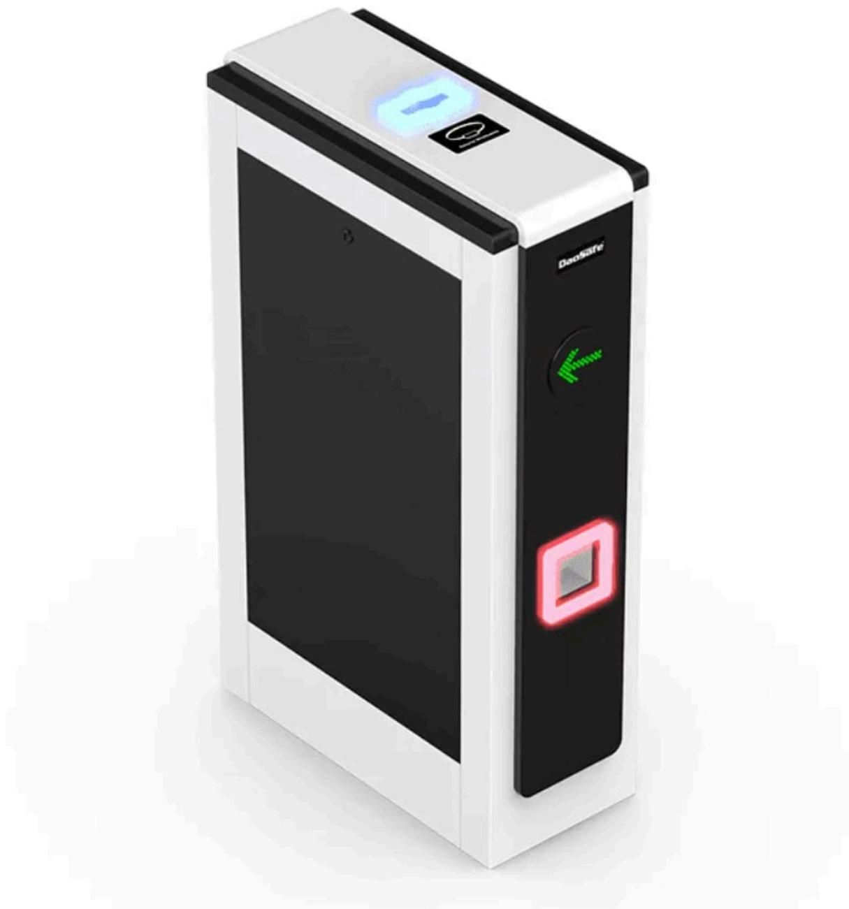
Браслетоприемник DSSP6001E — это оборудование для контроля доступа, позволяющая изымать браслеты. Например, при установке на выходе, если долгов нет - браслетоприемник забирает браслет и турникет проворачивается на выход, а если долг есть - браслет не принимается, турникет не открывается. Браслет при этом будет выпадать в окно выдачи.
