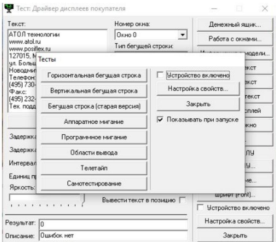
Нажимаем «настройка свойств» и меняем COM порт на тот, который отображается в диспетчере устройств. В диспетчере устройств дисплей покупателя подписан как Prolific PL2303GL (версия может отличаться). Скорость оставляем 9600, далее нажимаем «проверка связи» и убеждаемся в том, что все работает корректно.
