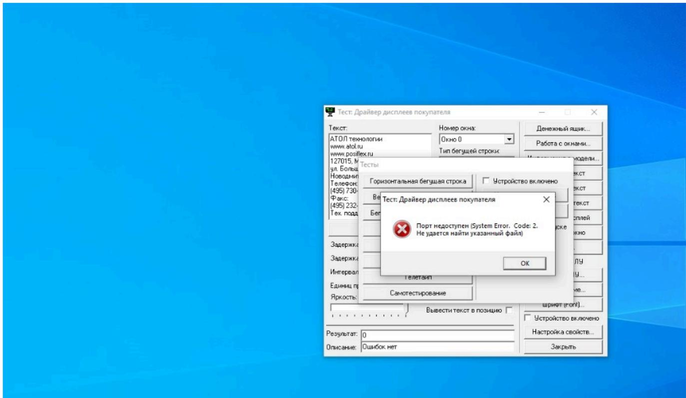
Значит неверно выставлен COM порт, проверьте какой COM порт отображается в диспетчере устройств. Выставьте нужный или попробуйте переподключить в другой порт, может быть на ПК данный порт нерабочий.
