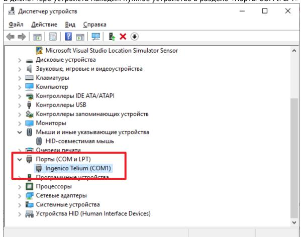
2. Выбрать устройство, открыть его свойство и на вкладке «Параметры порта» нажать «Дополнительно»
