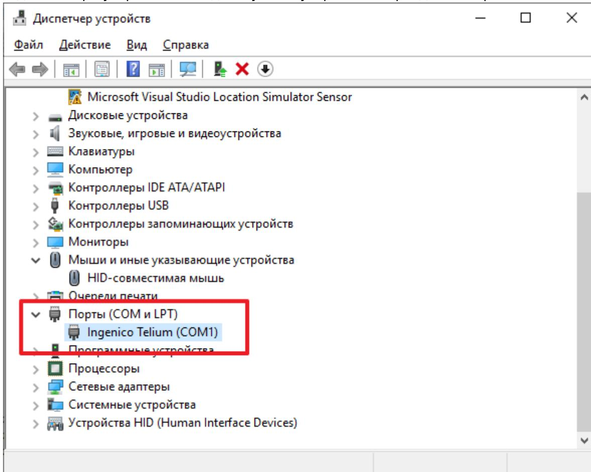
2. Выбрать устройство, открыть его свойство и на вкладке «Параметры порта» нажать «Дополнительно»
