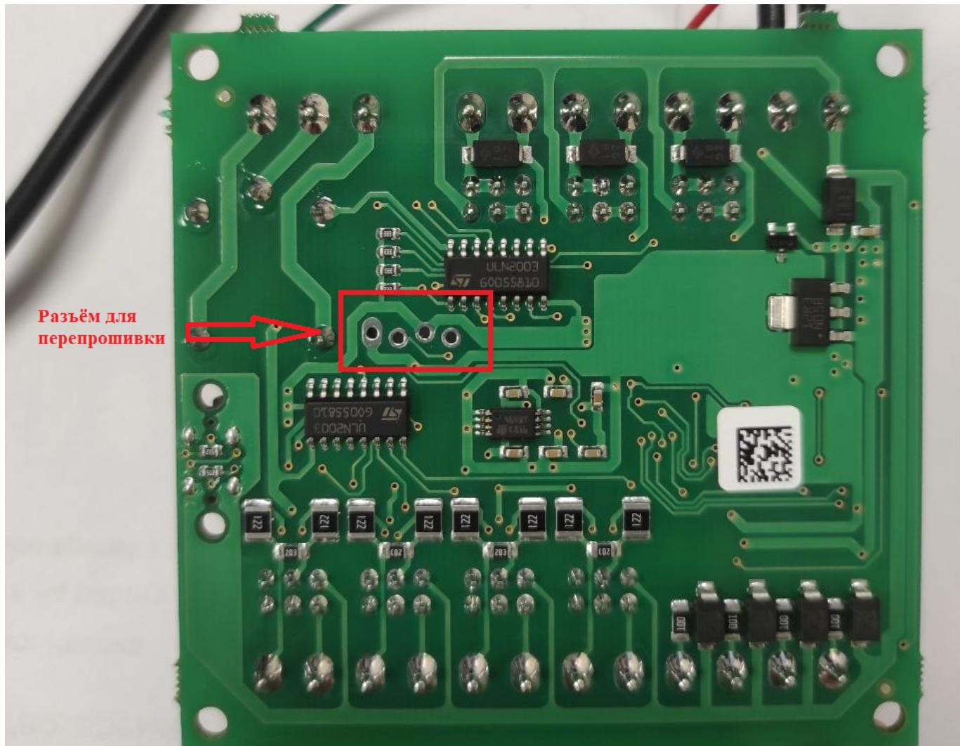
**Важно:** Подключать программатор к плате так, чтобы изображение треугольника на проводе программатора входило в овал на плате:
