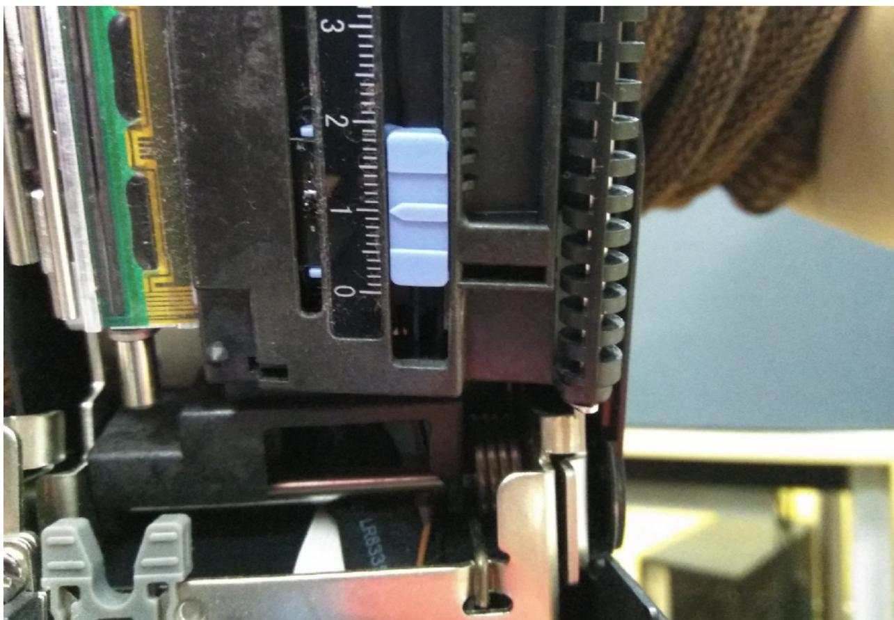
3. Установите фиксатор ленты сзади так, чтобы он держал ленту.
