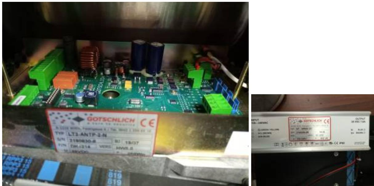
Подключение валидатора происходит по схеме на стр.13 из «Gotschlich - Инструкция по монтажу и настройке тумбовых 2-х, 3-х штанговых и роторных турникетов Vario» v.5.2 A именно на колодке беспотенциональных выходов В и/или С:
