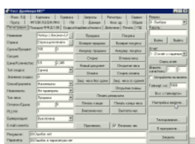
В поле «Порт» выбираем COM 8 . Нажимаем «Проверка связи » в поле « Результат » должно отобразиться имя подключенного фискального принтера. (Если не отображается , меняем в
