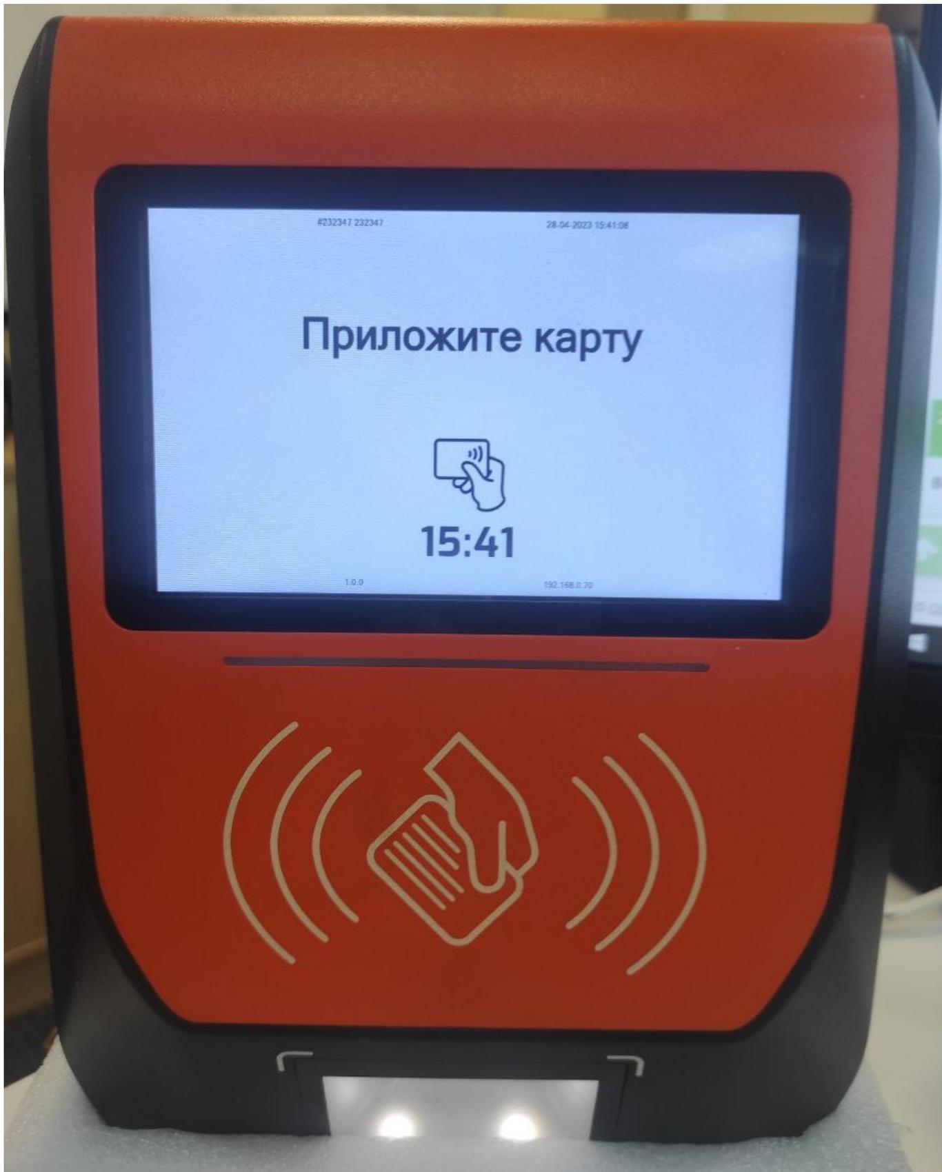
Валидатор на объектах часто используют в паре с турникетом: посетитель прикладывает карточку (другой носитель) к валидатору, происходит проверка права прохода и в зависимости от результата проверки, на экран валидатора выводится сообщение о разрешении/запрете прохода. Если проход разрешён, то рога турникета разблокируются, и посетитель проходит в зону услуги, если же проход запрещён, то рога турникета остаются в заблокированном режиме.
