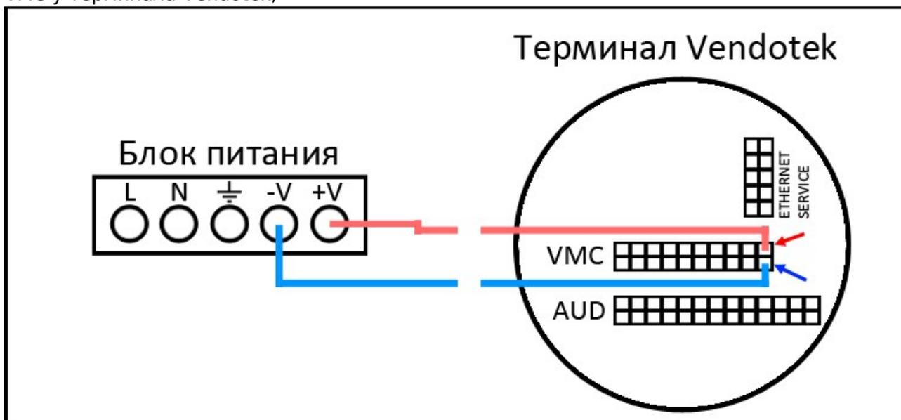
6. Соедините -V и +V зажимы выходов *того же блока питания* со соответствующими контактами модуля реле;
