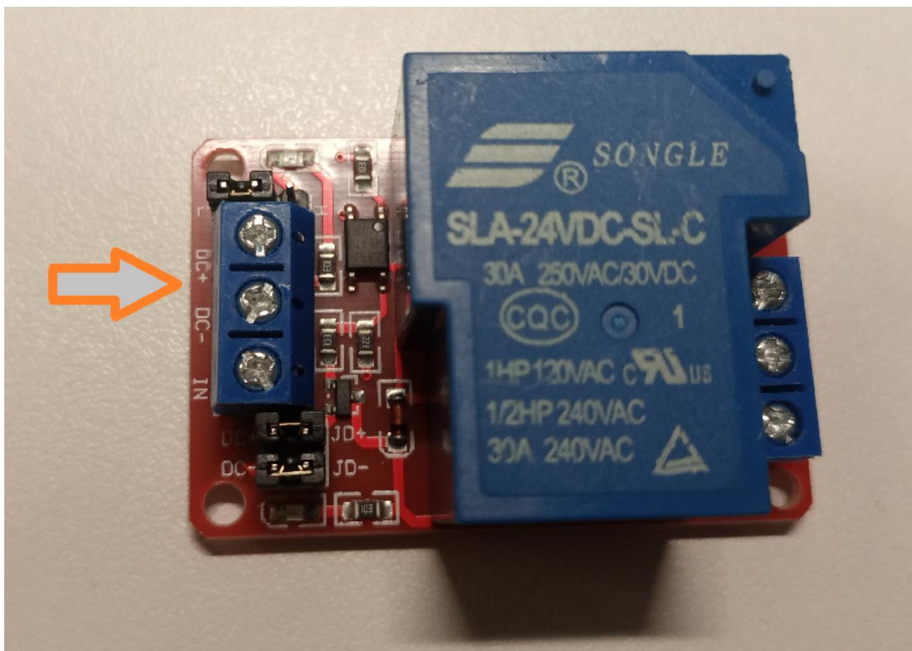
7. Зелёный провод PULSE от терминала Vendotek подключите к контакту IN реле. Чёрный провод подключается к GND, общей земле питания;
