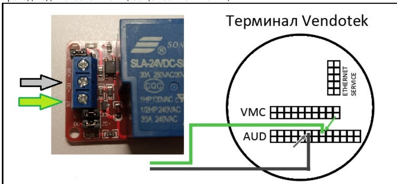
8. Контакты NO COM и NC являются «сухими» выходами реле. Для подключения контактов турникета для открытия обычно используются нормально-открытый NO и общий COM
