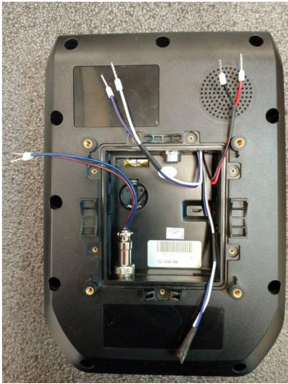
**Питание валидатора(12-24В постоянного напряжения):** пара **коричневого (+)** и **синего (-)** проводов.
