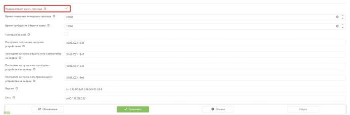
**Настройка «Поддерживает конец прохода»** означает, что при прикладывании карты (либо другого носителя) к валидатору, контроллер обрабатывает сигнал «Конец прохода», выставляемого турникетом по факту **проворота рогов**. В данном режиме **списание средств (оплата)** производится только после получения контроллером данного сигнала от турникета.
