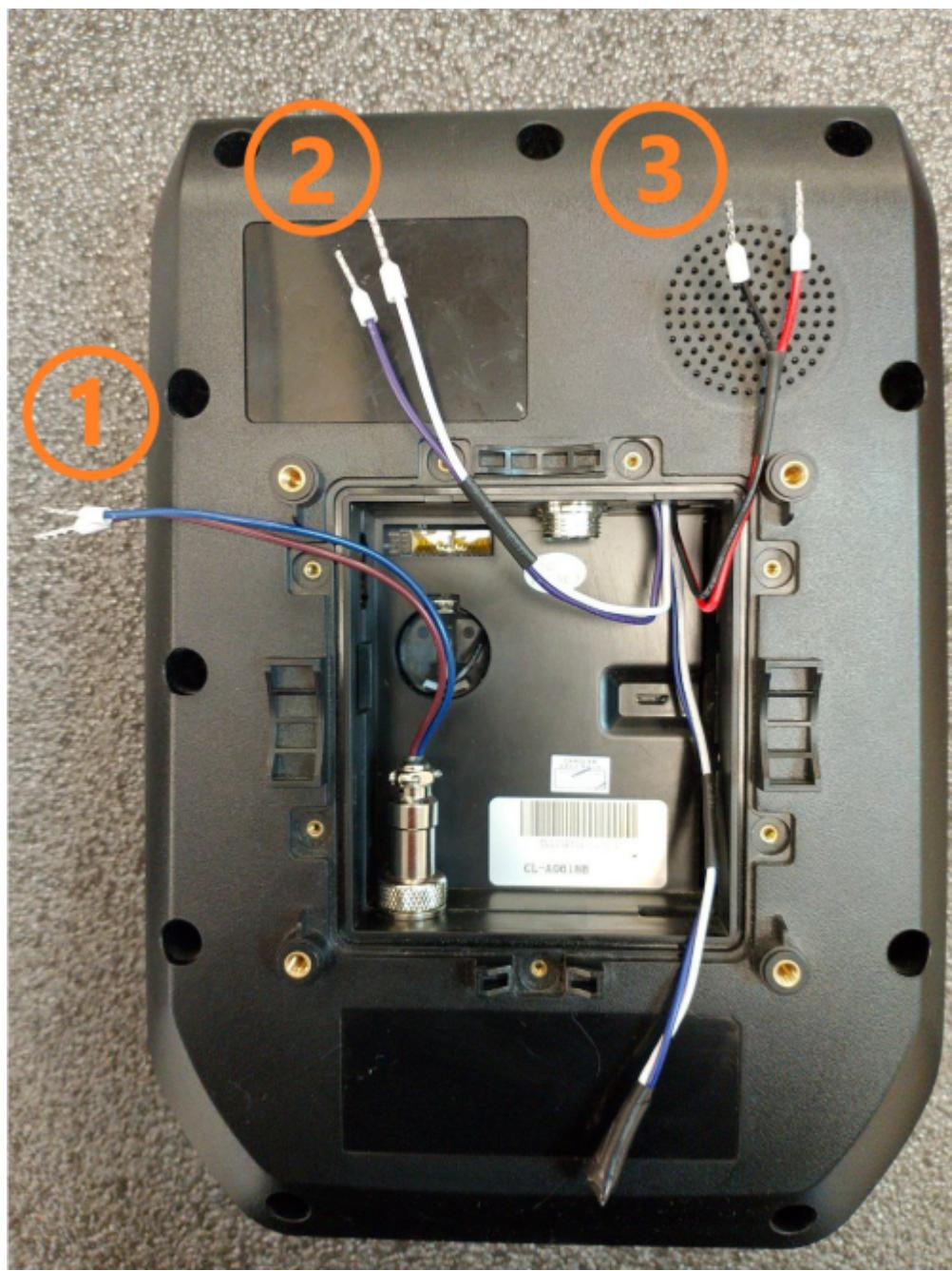
**1) Питание валидатора(12-24В постоянного напряжения):** пара **коричневого (+)** и **синего (-)** проводов.
